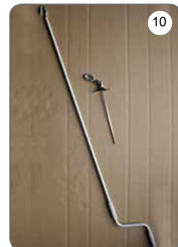
Korba, przegub Cardana 45° lub 90° z uchem [10].
